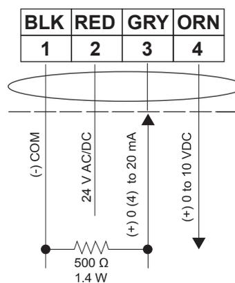
图5: DC模拟电流控制
